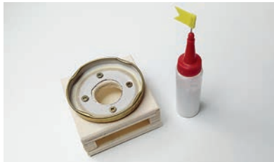
lepljenje pozicije 4 na zlepljene pozicije 1 in 2
